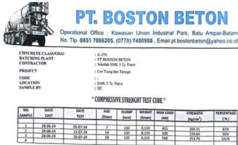
Gambar 10 Hasil Uji Tekan Beton
